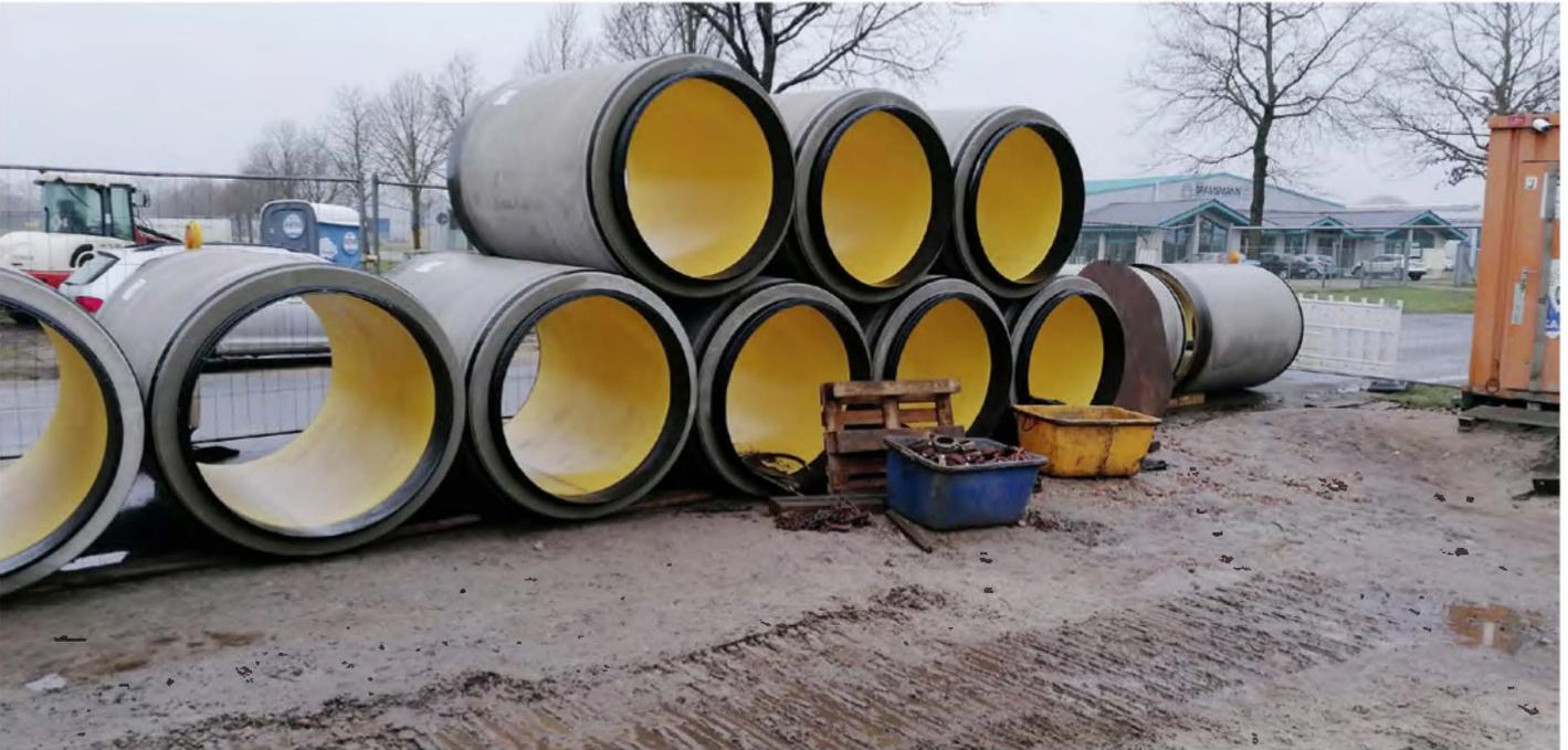
Die schalungserhärteten Stahlbeton-Vortriebsrohre DN 1200 mit PEHD-Liner, einer Baulänge von 2,0 m und einer Wandstärke von 145 mm auf der Baustelle in Haren | Foto: Müller Beton
