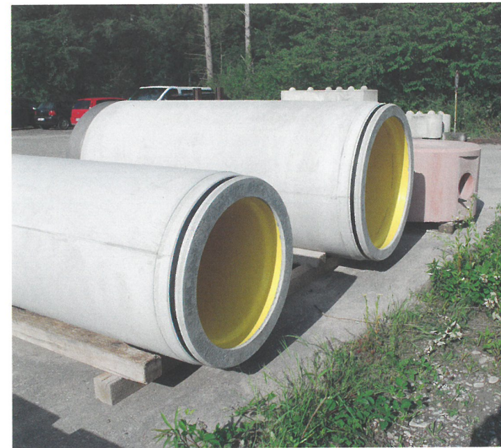
Die Spitzenden der in der Schalung erhärteten Vortriebsrohre werden separat vorentschaft. Eine nach Aussagen von Christian Weinberger bisher weltweit einzigartige Funktion der Betonrohrgießformen.
