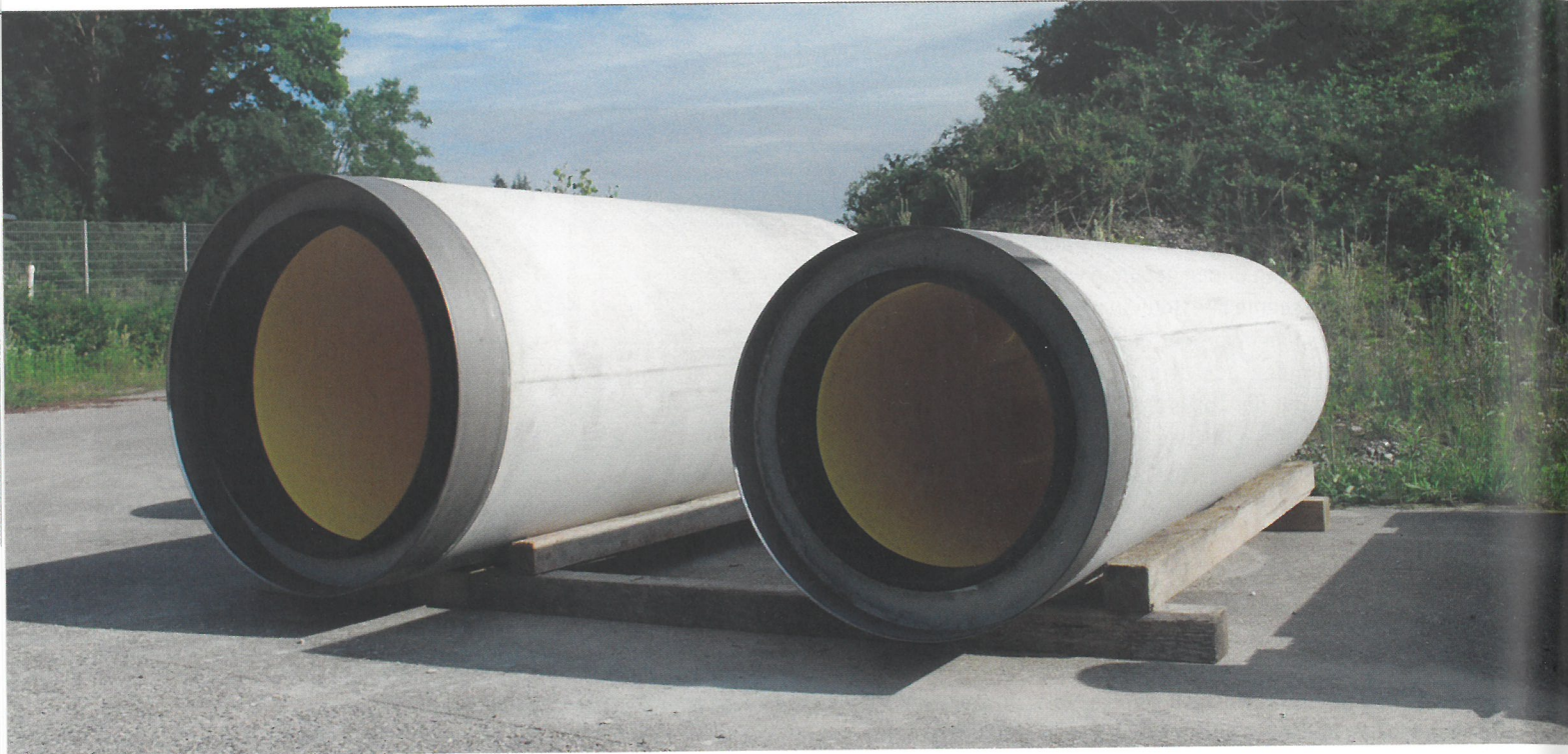
Die beiden ersten in Breisach produzierten Rohre sind noch Prototypen. Gut zu erkennen: Die Auskleidung mit dem PE-Inliner und der Connector, der für einen durchgehenden Korrosionsschutz und für einen dichten Fugenverschluss sorgt, ohne die Gelenkigkeit des Rohrstranges einzuschränken.
