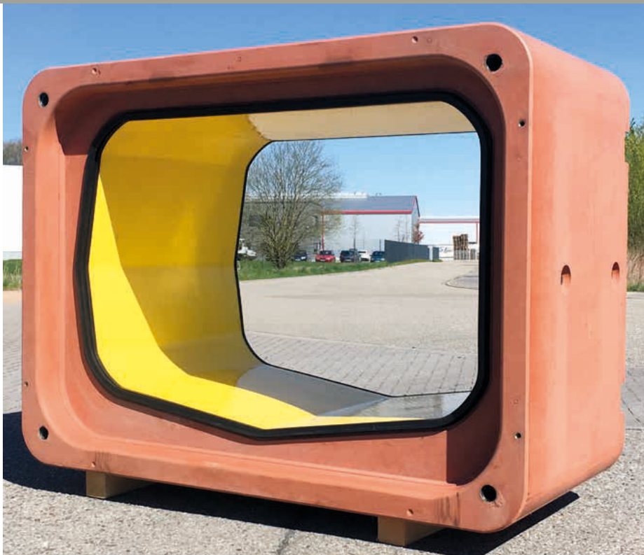
Großer Querschnitt mit niedriger Bauhöhe: Perfect Box mit Innenauskleidung aus PE. Das Profil ist sowohl auf einer breiten als auch auf einer schmalen Seite mit einer Trockenwetterrinne versehen.
